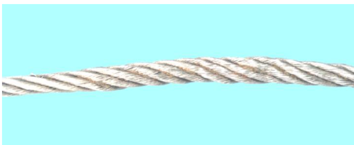
Рисунок Д.24 – Сплющування (перетискання каната)
