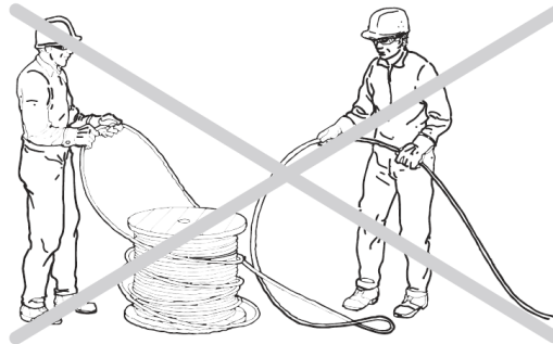
Рисунок Е.3 – Неправильні способи розмотування каната
