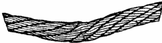
Рисунок Д.29 – Викривлення каната
