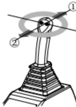
Рисунок 12 – Управління механізмом висування-втягування стріли
