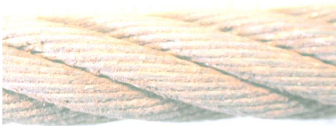
Рисунок Д.11 – Поверхня дротів шорстка, корозія розподілена рівномірно по довжині каната. Ступінь ушкодження – 20 %
