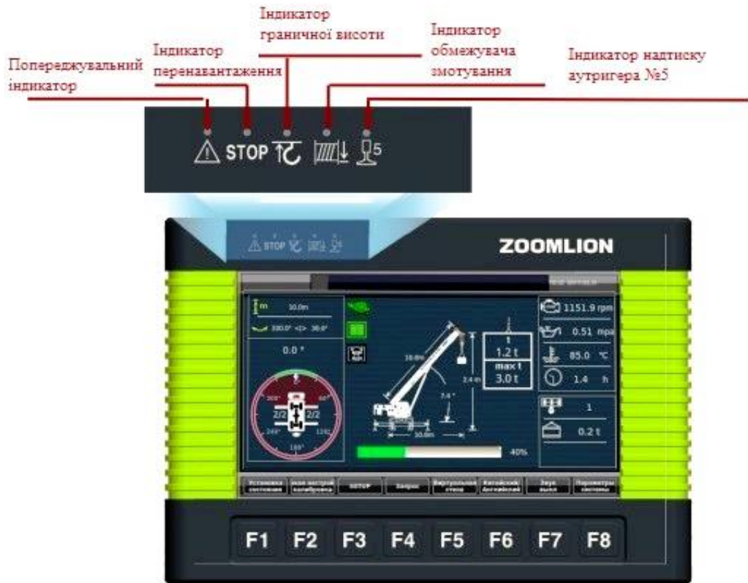
Рисунок 5 – Зовнішній вигляд панелі інструментів обмежувача вантажного моменту
