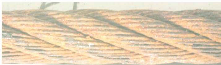
Рисунок Д.13 – Поверхня дротів сильно уражена точковою корозією, виразки на дротяніх, ослаблені дроти, просвіти між дротиками. Ступінь ушкодження – 100% - Вибракування каната.
