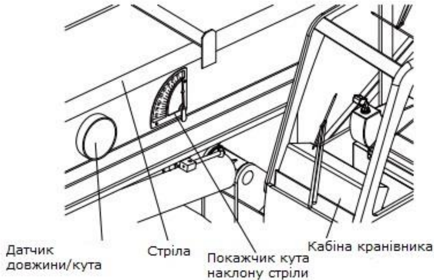
Рисунок 12 – Вказівник кута нахилу стріли та датчик кута
