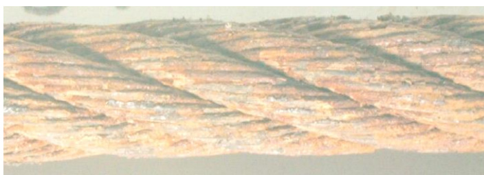
Рисунок Д.12 – Поверхня дротів сильно уражена окисленням, рівномірно довжиною каната. Ступінь ушкодження – 60 %
