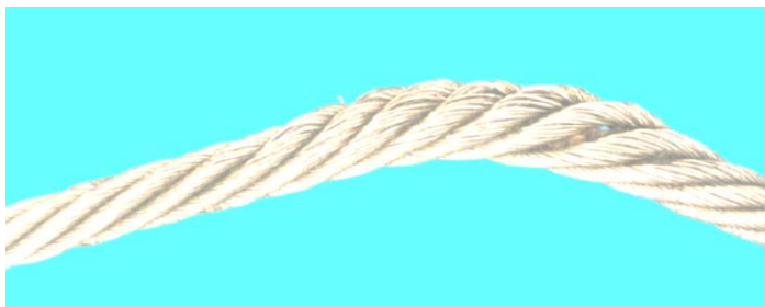
Рисунок Д.23 – Сплющування (перетискання каната)
