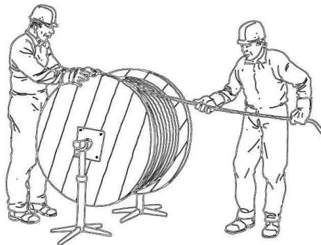
Рисунок Е.2 – Розмотування каната з бобіни
