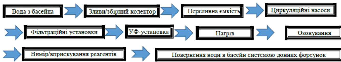
Схема 1. Вертикальна технологічна схема рециркуляції води в басейні
