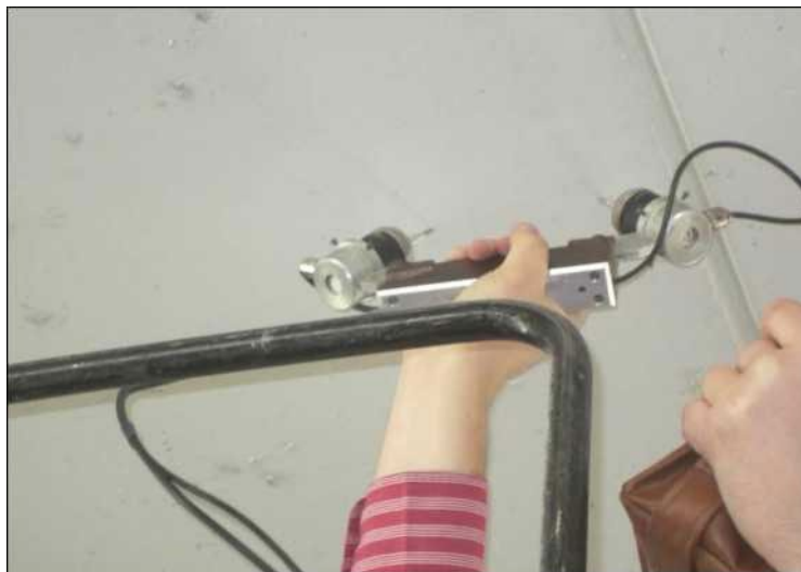
Рисунок 5.1 - Інструментальні дослідження ультразвуковим методом (прилад УК-14П)
