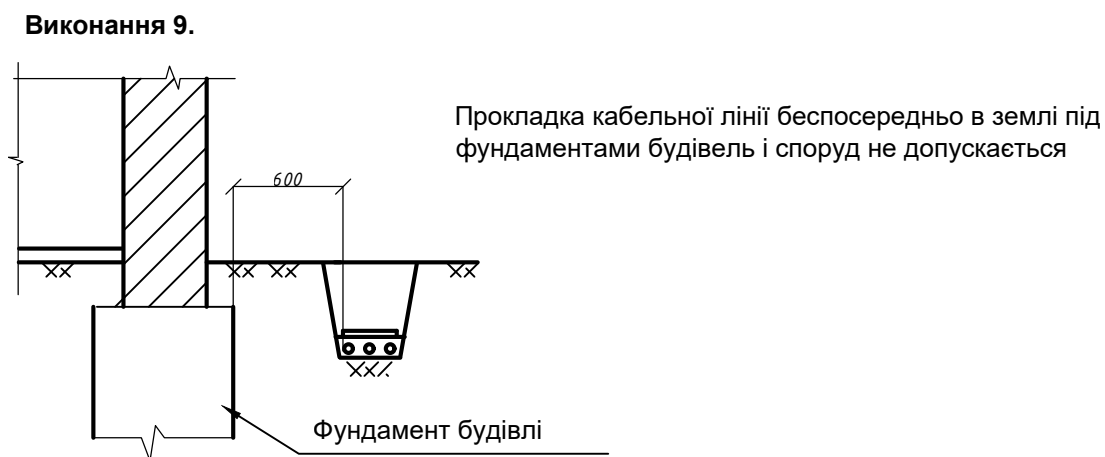
3-3 Прокладка кабельної лінії паралельно фундаментам будівель
